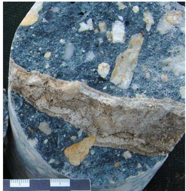
Bild 10: Schwindrissbildung, Schädigungszone im Rissbereich
