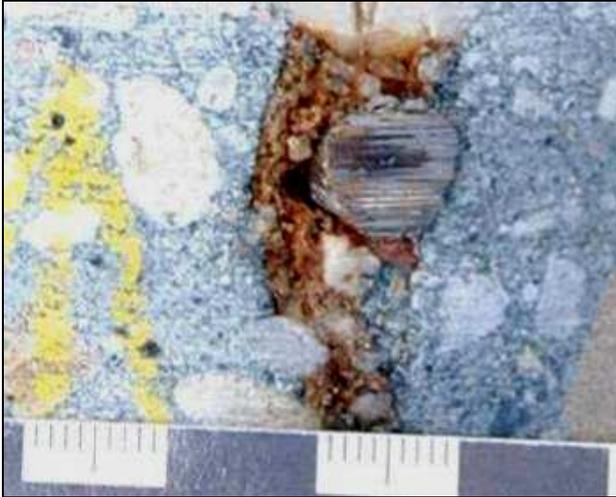
Bild 11: Säureangriff auf Betonstahl im Rissbereich
