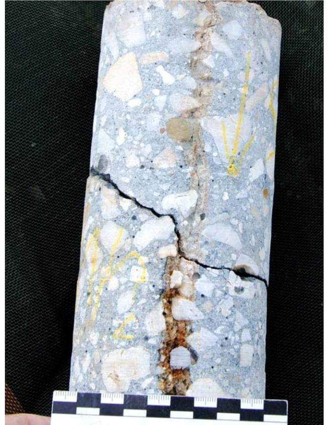
Bild 9: Überbohrte Schwindrissbildung, untern Angriffsseite, oben Luftseite der Silowandung
